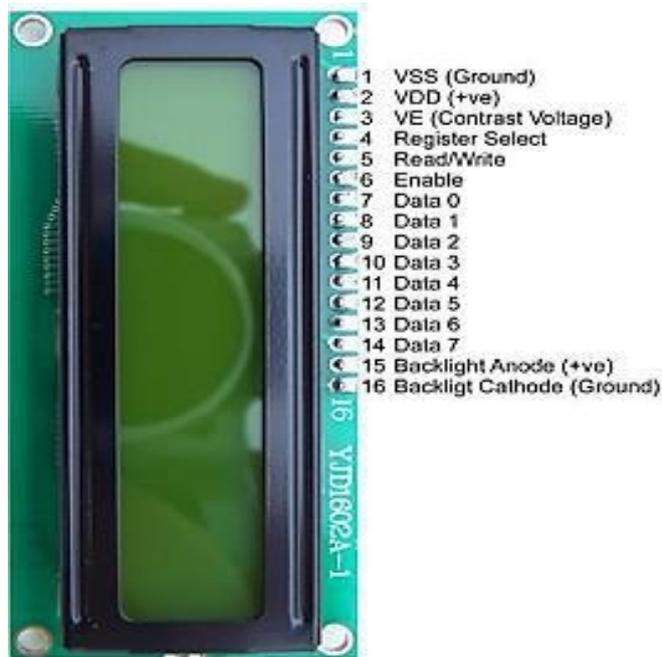
Gambar 4. Jalur input dan kontrol LCD
