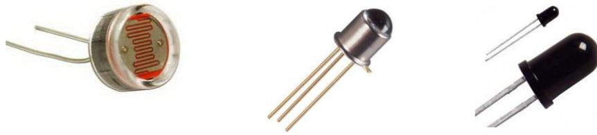
Gambar 5. Bentuk Fisik LDR (kiri), Photo Transistor (tengah), Photo Diode (Kanan)
