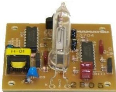
Gambar 6. Bentuk Fisik Modul Sensor Cahaya Uvtron
